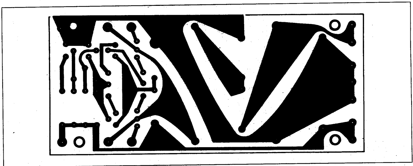
9. ábra. Nyomtatott áramköri rajz a 8. ábrán látható kapcsoláshoz (M 1:1)
